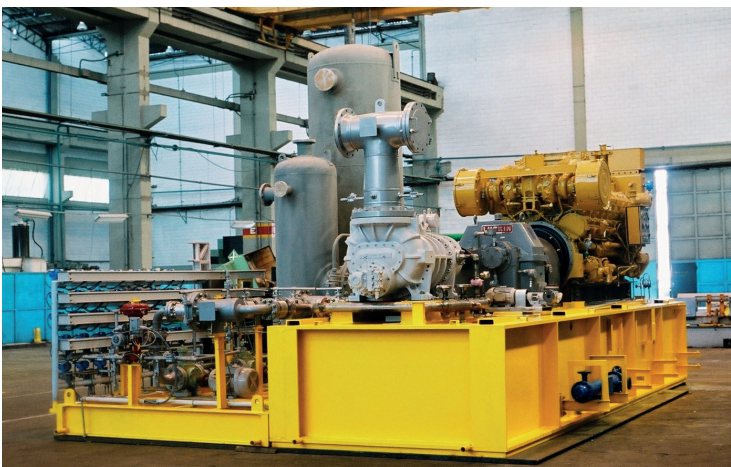
UNIDAD RECUPERADORA DE GASES
