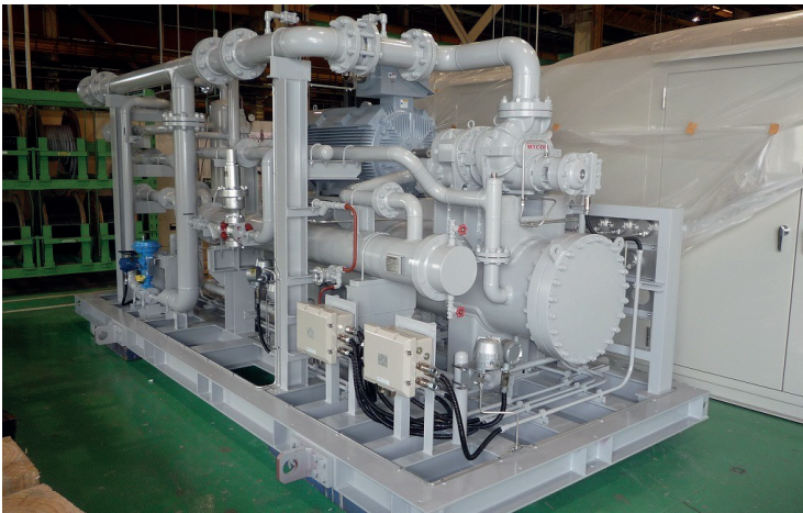
UNIDAD DE COMPRESIÓN PARA TURBINA DE GAS
